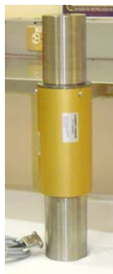
Figura 11. Transductor de transferencia de par torsional de 20 kN·m.
